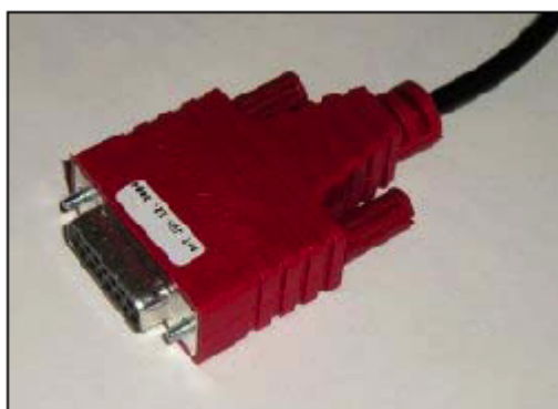
Жгут для периферийного устройства, используемого для аудита с применением протокола DEX (DEX Audit)
